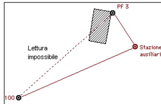
Qualora esistono impedimenti di lettura diretta sui punti da rilevare, è consentito l'uso di stazioni isolate atte a determinare la mutua posizione fra le stesse e punti da rilevare (esempio 17)
