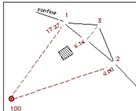
(direzione azimutale e distanza) due o più punti ausiliari e legando a questi ultimi il punto invisibile con distanze direttamente osservate (esempio 22).
