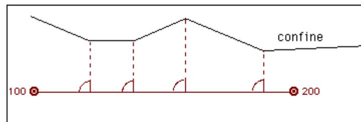
E' consentito determinare uno o più punti di dettaglio integrando il rilievo celerimetrico con allineamenti e squadro. Gli allineamenti possono essere realizzati indifferentemente tra le stazioni di rilievo e/o tra punti determinati con rilievo polare purché vengano rispettate le relative norme previste per gli allineamenti (esempio 23).
