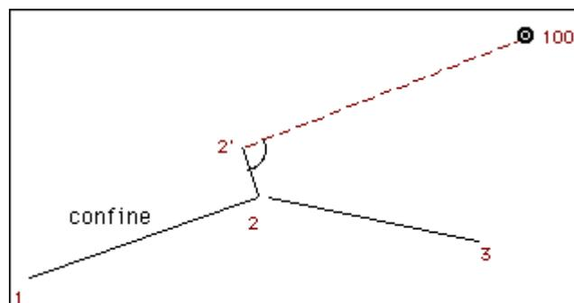
E' consentito determinare la posizione di uno o più punti non osservabili dalla stazione di rilievo individuando sul terreno un punto ausiliario posto a distanza non superiore al metro rispetto al punto invisibile e in posizione tale da realizzare un angolo retto con la direzione della stazione.
