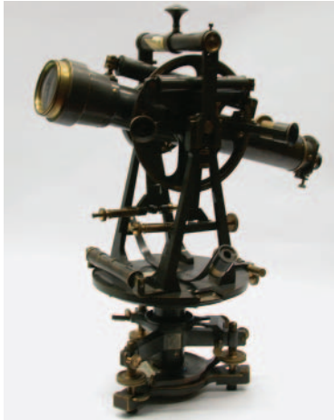
Grande teodolite ottico meccanico, XIX secolo, Salmoiraghi. Istituto Belzoni. Collezione aula di topografia.
