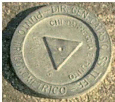
Punto Fiduciale GPS (trigonometrico su piastra su cordolo del marciapiede).
