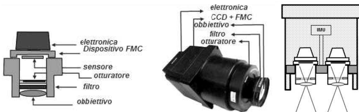
Figura 29 - La singola camera di base e il montaggio nel cilindro della camera composta
