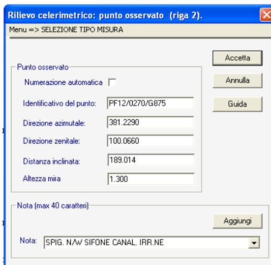
**Figura 1** - Maschera di acquisizione dei dati di celerimensura
