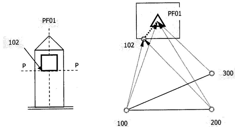
La sezione del libretto delle misure per il trasporto del dislivello (nullo) tra il punto 102 ed il PF01, sarà costituita da una coppia di righe altimetriche, previste per la livellazione da un estremo, una di tipo 4 ed una di tipo 5, come di seguito riportato:
